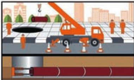
การตักทอ (Pipe Jacking)
