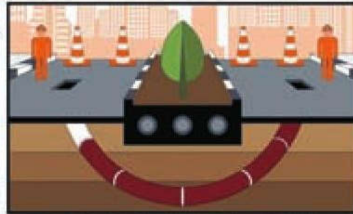
การตักทอ (Horizontal Directional Drilling)
