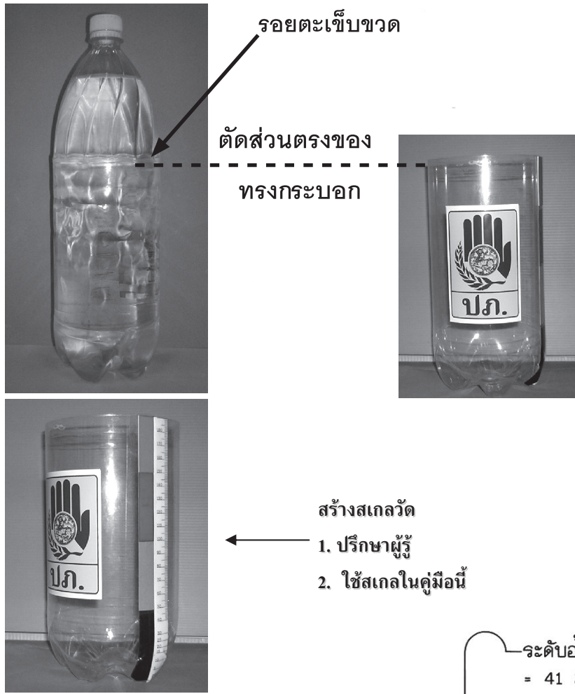
รูปวิธีที่ 2 การทำกระบอกวัดน้ำฝนจากขวดน้ำอัดลม
